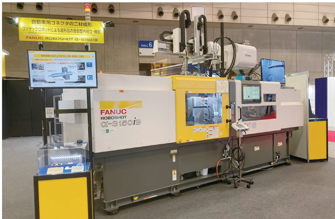
写真1 ロボショットα-S150iB（最大型締力：1,500kN）による防塵防水コネクタ成形システム
